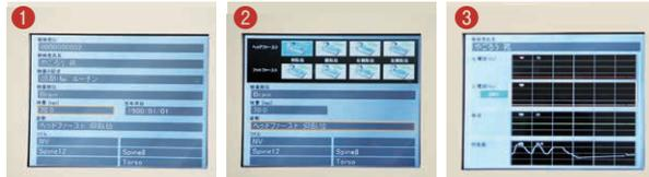
本体のWIT Monitor。患者基本情報の参照・修正①、コイルの装着状態②、心電図や呼吸の波形③、などをモニタすることができる。
